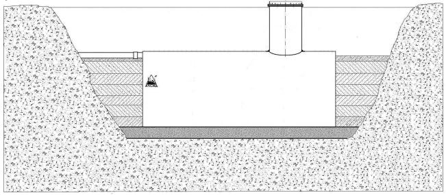
Установить датчик уровня ( при варианте поставки с датчиком уровня). Датчик крепится на монтажной планке. Установите защитную трубу кабеля датчика в отверстие находящееся в верхней части колодца. Кабель датчика в защитной трубе протягивается к зданию. Оставьте в техническом колодце установки кабель достаточно длинным, чтобы датчик можно было достать для обслуживания.
