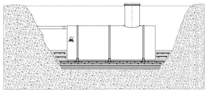
Обратная засыпка производится песком с цементом в пропорции 5:1. Засыпать первый слой грунта (20-30см), выверить горизонтальность емкости. Утрамбовать первый слой грунта пневмотрамбовками или пролить водой. Произвести обратную засыпку установки до уровня выводов подводящих и отводящих трубопроводов. Засыпка производится слоями по 20-30см с тщательным уплотнением каждого слоя и выверкой горизонтальности емкости.
