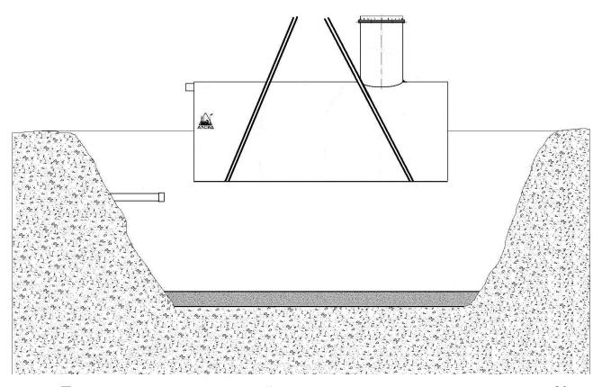
После установки емкости на слой песка, следует залить в нее воду на высоту 20см для обеспечения устойчивости при дальнейших монтажных работах.
